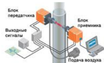
Рис. 2. Спосіб вимірювання концентрації димових газів упоперек перерізу газоходу [12]
