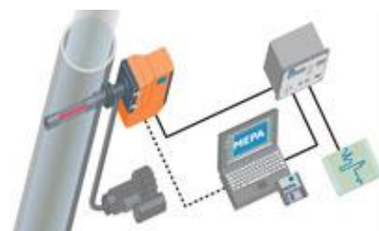
Рис. 3. Спосіб вимірювання концентрації димових газів з вимірювальною щілиною [12]
