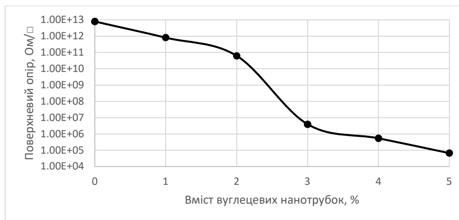
Рисунок 4.5 – залежність поверхневого опору поліуретанових волокнистих матеріалів від вмісту вуглецевих нанотрубок
