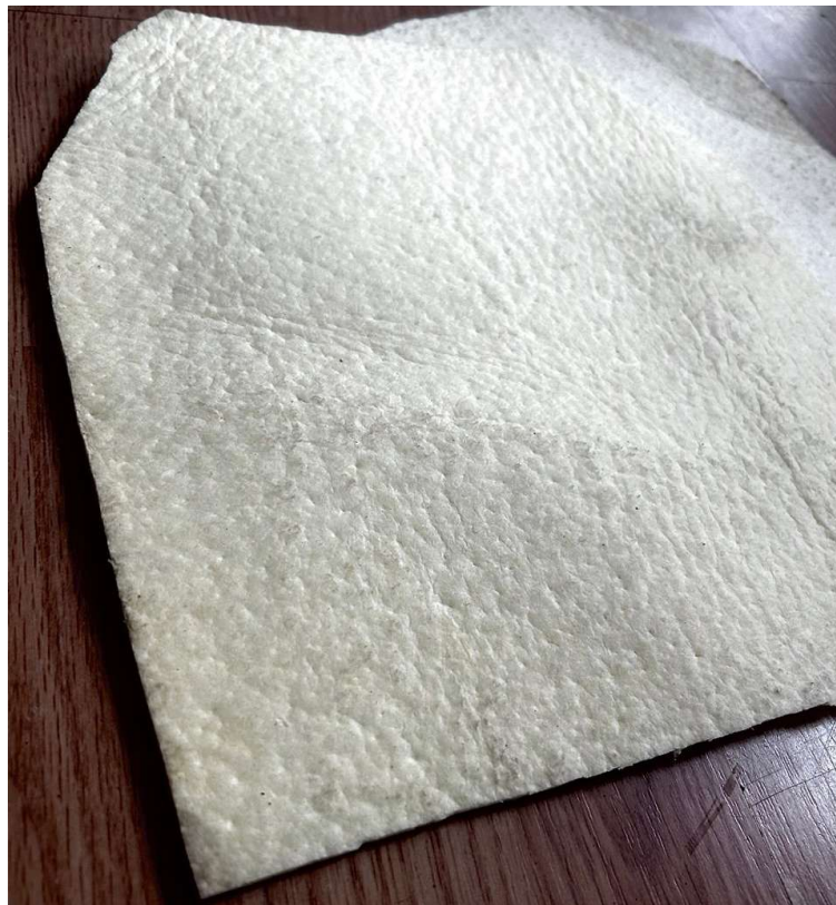
Рисунок 5.3 – Демпферні підкладки під бронепластили бронежилетів на основі термопластичного поліуретану.
