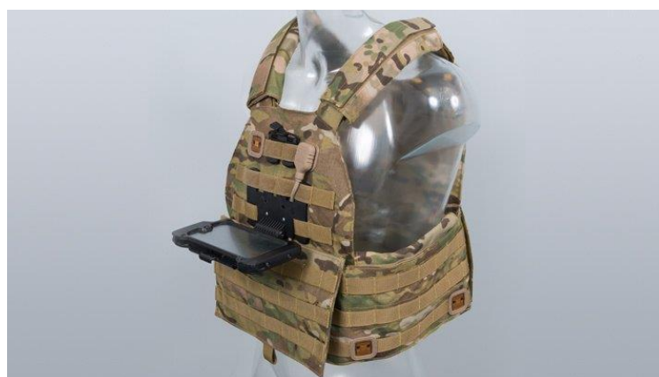
Рис. В.29. Бронежилет з електронним текстилем Broadsword Spine, що включає мережу зв'язку та живлення, «BAE Systems», «Intelligent Textiles Limited», Велика Британія, 2016 р. [280]
