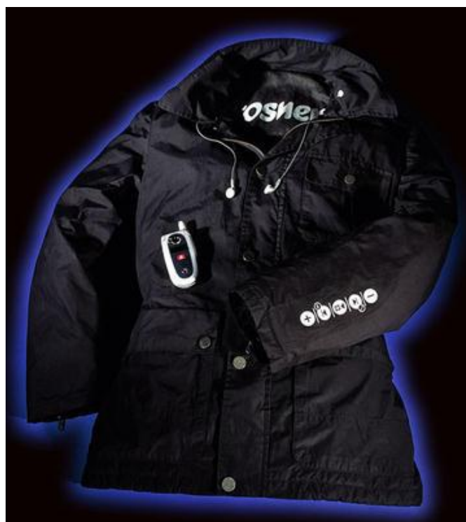
Рис. В.6. Куртка Mp3Blue з вбудованим MP3-плеєром та Bluetooth-з'єднанням, «Infineon Technologies», «Rosner», Німеччина, 2004 р. [155]
