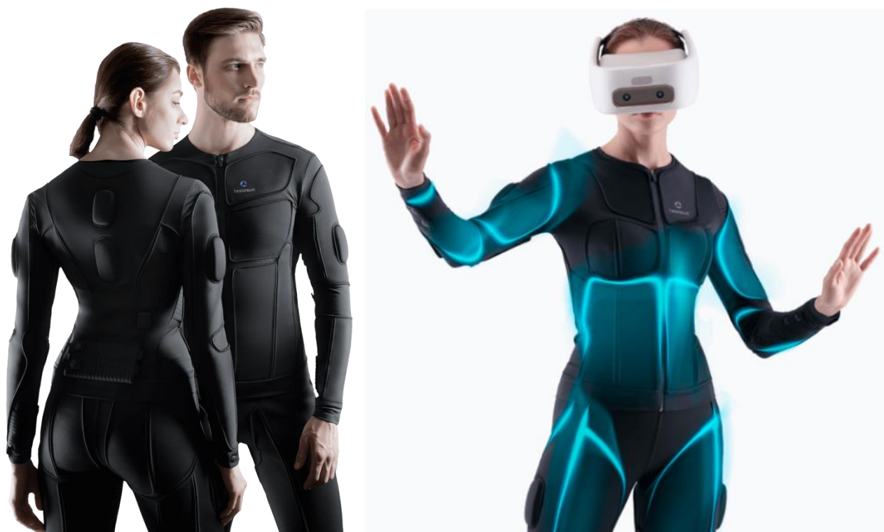
Рис. В.36. Костюм Teslasuit 4 з тактильним зворотнім зв'язком, «Deep Divers», Велика Британія, 2016 р. [298]
