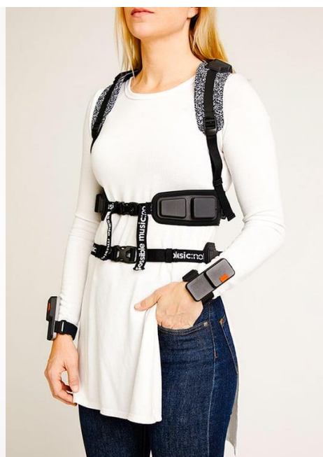
Рис. В.67. Жилет з вібрomodулями для людей з порушенням слуху, «Not Impossible Labs», США, липень 2023 р. [315]
