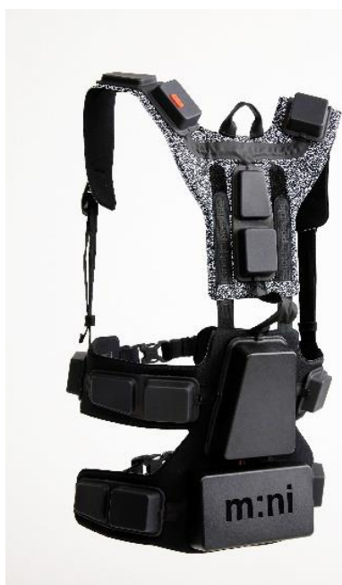
Рис. В.67. Жилет з вібрomodулями для людей з порушенням слуху, «Not Impossible Labs», США, липень 2023 р. [315]
