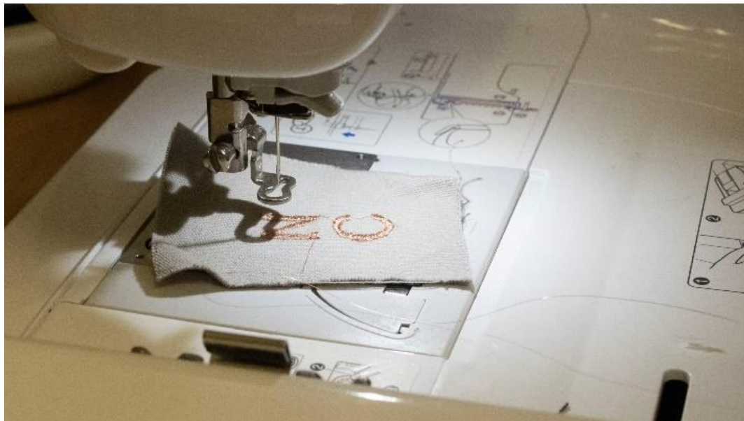
Рис. В.63. Вишивка з енергогенеруючих ниток на текстилю, Університет штату Північна Кароліна, США, листопад 2022 р. [227]
