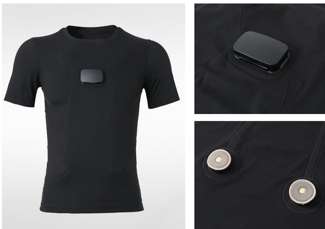
Рис. В.24. Футболка Smart Healthcare для відстеження серцевого ритму, «Renben Technology Clothing», Китай [150]
