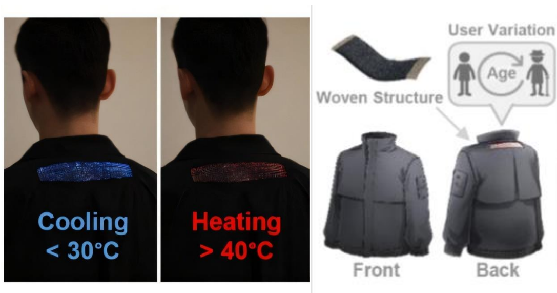
Рис. В.91. Смарткуртка для регулювання температури та запобігання перегріву, Американське хімічне товариство, США, Лабораторія штучного інтелекту в дизайні, Китай, лютий 2025 р. [224]
