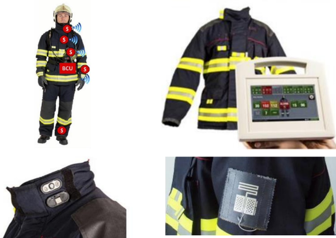
Рис. В.33. Костюм для моніторингу фізіологічного стану пожежників та виявлення токсичних газів, Західночеський університет у Пльзені, Чехія, 2014 р. [285]
