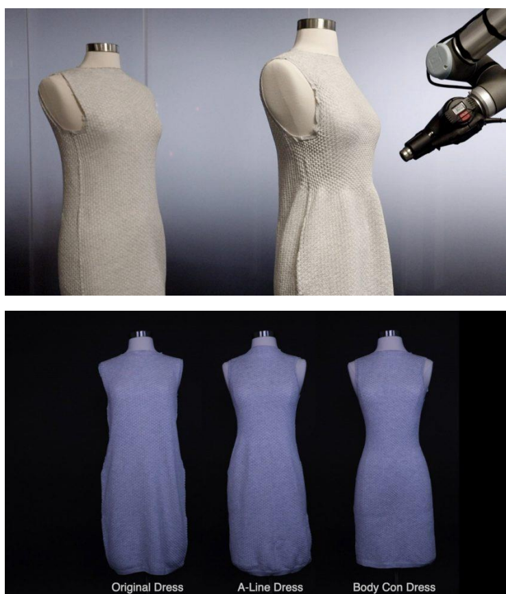
Рис. В.86. 4D-трикотажна сукня, що змінює форму під дією тепла, Массачусетський технологічний інститут, США, січень 2024 р. [69]
