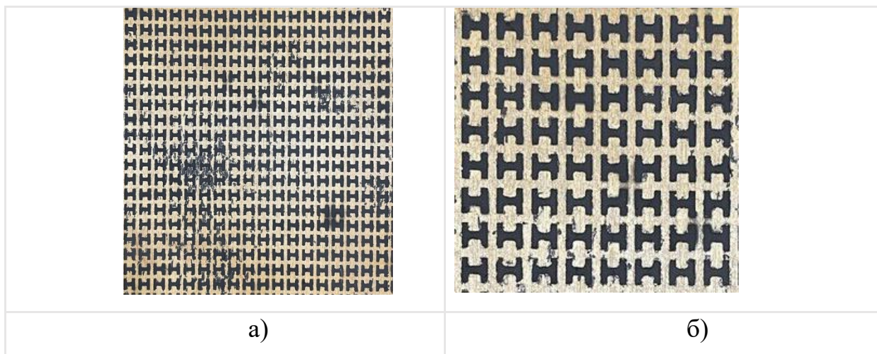
Рисунок 5.6 – Жорсткий мета матеріал зразок №1: а) Загальний вид метаструктури; б) Деталізований вид з близька.
