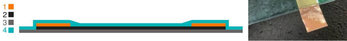
Рисунок 4.30 – Схематичне зображення конструкції нагрівального елемента методом ламінації мідної шини на КЕП (варіант виконання № 3): 1 - мідна шина; 2 - шар КЕП; 3 - субстрат; 4 - ламінація.
