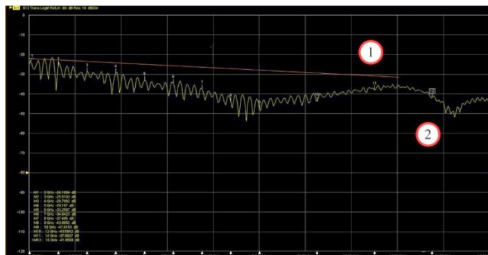
Рисунок 5.13 – Порівняння відбиття радіохвиль металу та гнучкої метаструктури зразок №4: 1- апроксимована базова лінія відбиття металу як вихідний рівень для порівняння; 2- гнучка метаструктура у порівнянні з базовою лінією металу.
