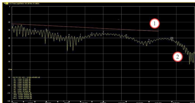
Рисунок 5.9 – Порівняння відбиття радіохвиль металу та метаструктури зразок №2: 1- апроксимована базова лінія відбиття металу як вихідний рівень для порівняння; 2- метаструктура у порівнянні з базовою лінією металу.
