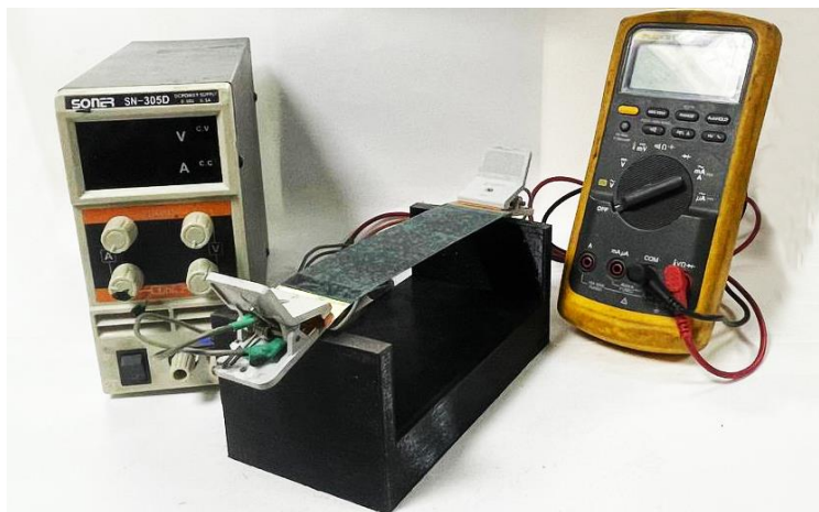
Рисунок 2.24 - Лабораторна установка для вимірювання вольт-амперних характеристик гнучких нагрівальних елементів.
