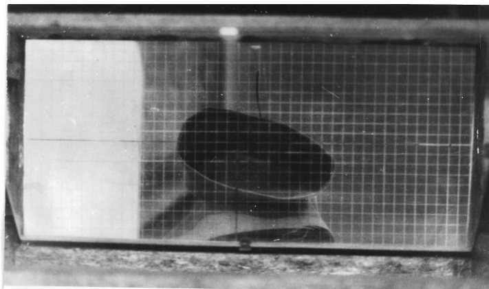
Рис. 2. Зображення проєкції низу рукава за допомогою установки для оцінки якості посадки плечових виробів
