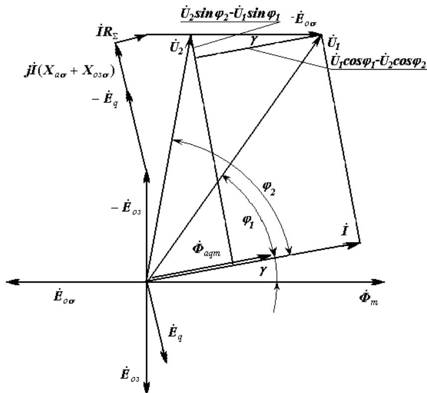
**Векторна діаграма колекторного двигуна змінного струму з послідовним збудженням**
