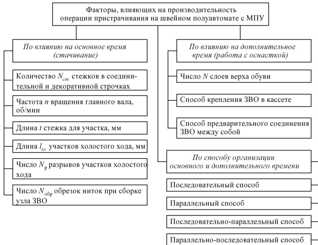
Рис. 2. Блок-схема классификации факторов, влияющих на производительность операции сборки ЗВО на швейном полуавтомате
