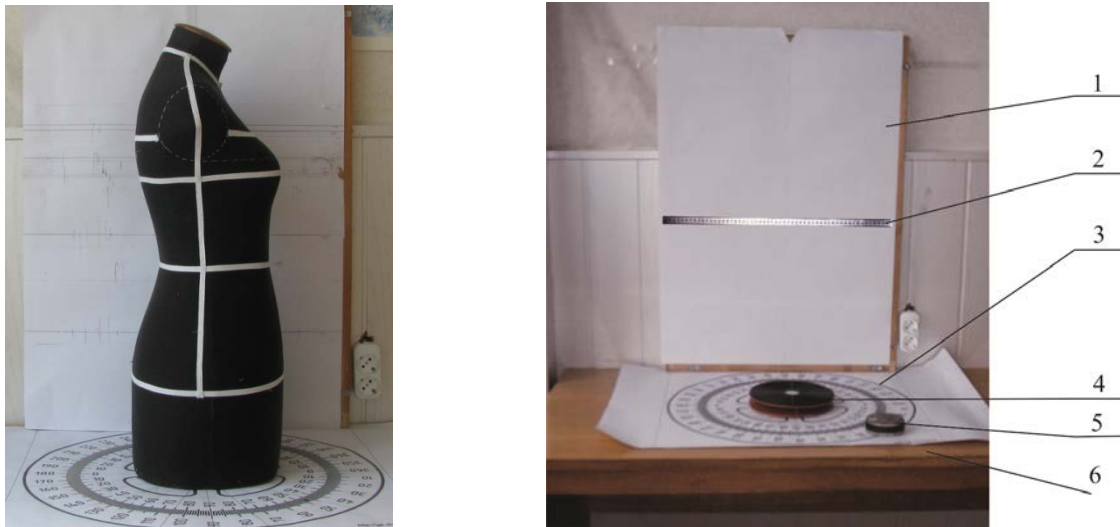
Рис. 1. Пристрій для визначення координат точок поверхні манекена і одягу: а – манекен жіночої фігури з горизонтальними, сагітальними та фронтальними лініями перерізів; б – загальний вигляд пристрою: 1 – аркуш паперу з нанесеними рівнями лініями грудей, талії, стегон та точок кутів пахвових западин; 2 – градуйована шкала, для визначення величин радіусів-векторів, мм; 3 – шкала, для визначення кутів повороту манекена, градус; 4 – платформа, для обертання манекена; 5 – магніт, який виконує функцію фіксатору манекену у статичному положенні; 6 – горизонтальна площина.
