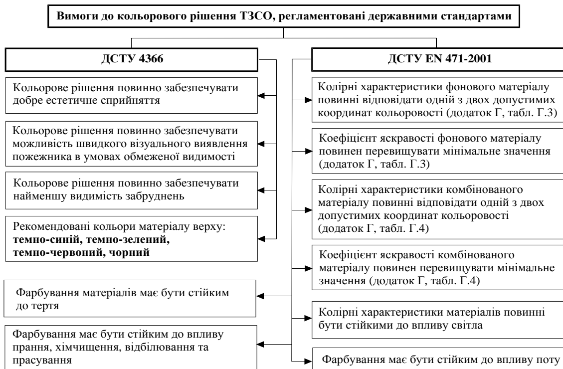
Рис. 2. Структурна схема вимог до кольорового рішення ТЗСО регламентованих державними стандартами України та Єврозони
