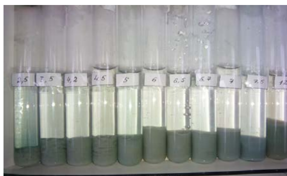
Рис. 4 Стійкість хром-модифікованих дисперсій монтморилоніту при різних рН
